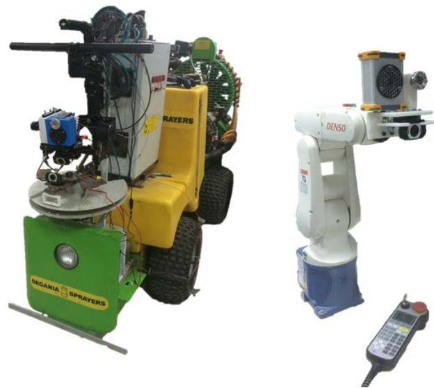
איור 5: מערכת הסונר המותקנת על זרוע רובוטית (ימין) ועל פלטפורמה (שמאל).
