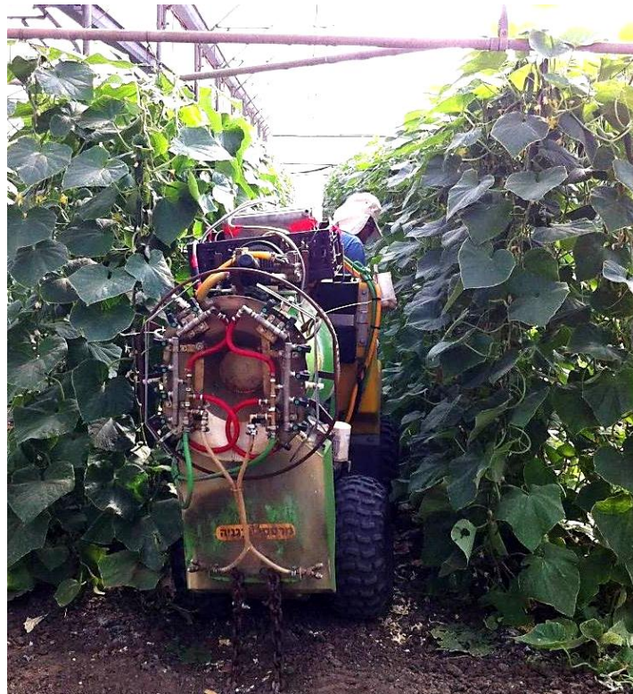
ציור 4 – מערכת ריסוס אלקטרוסטטית מותקנת על מרסס צ'יקו לחממת עגבניות ומלפפון.
