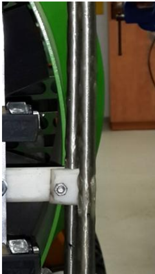
ציור 12 – אלקטרודה עטופה בשרוול שקוף של חומר פלסטי מבודד.
