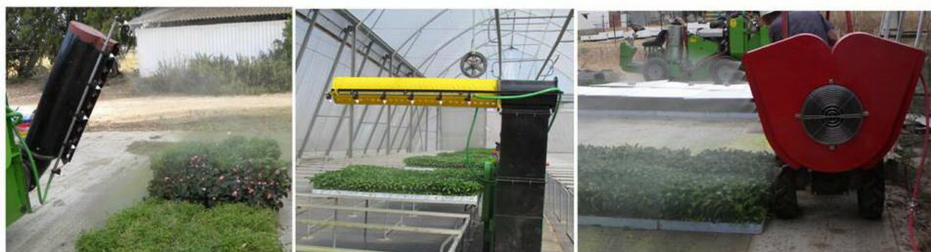
איור 1. מרסס מתנייע ריקשה עם בית מפוח יחודי (ימין). מרסס מתנייע יעודי עם שרוול אויר אופקי (מרכז). מרסס מתנייע יעודי עם מפוח רדיאלי מקביל ומוצא בעל שטח משתנה (שמאל).
