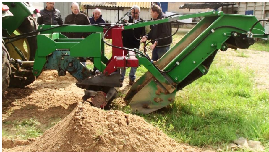
תמונה 1. בחינת ייתכנות השימוש ברוטור בעל ציר אופקי לחפירה והסעת קרקע
