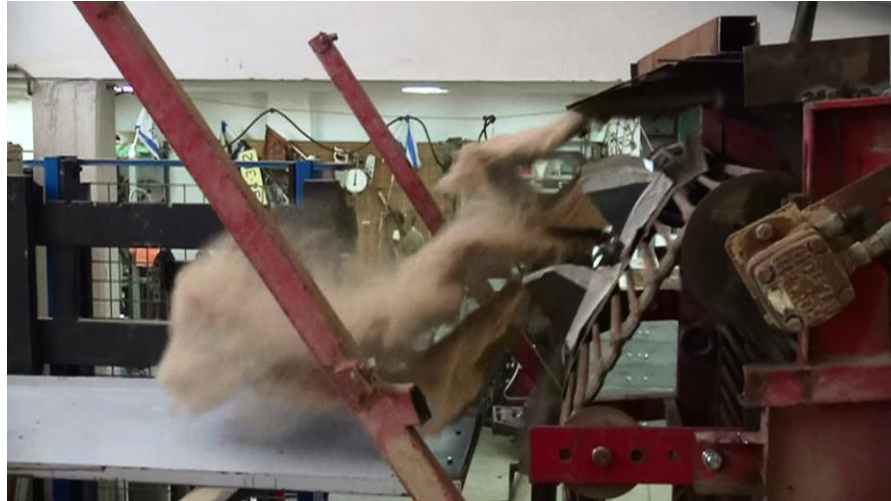
תמונה 2. בחינת ייתכנות השימוש במסוע כפות אנכי להסעה ופינוי של קרקע
