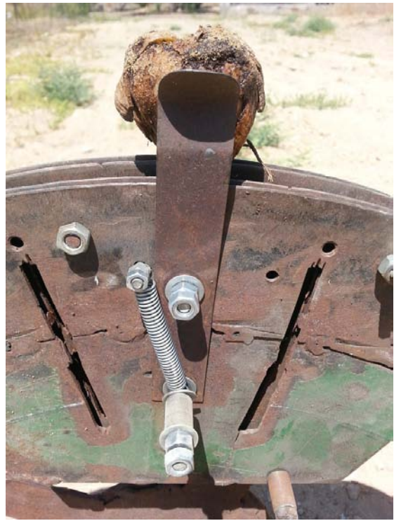
צור 7 תפסנית קפיצים, דגם מתקדם הקפיצים בולטים מהקרוסלה וחובקים את הפקעת בעדינות
