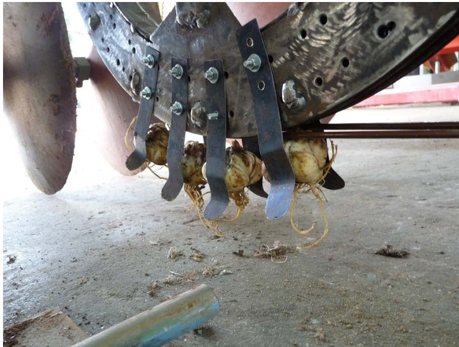
ציור 3. תפסנית מפלדה קפיצית לפקעות. השחרור לקרקע נעשה ע"י שני רצועות עגולות למניעת לנזק לניצנים.
