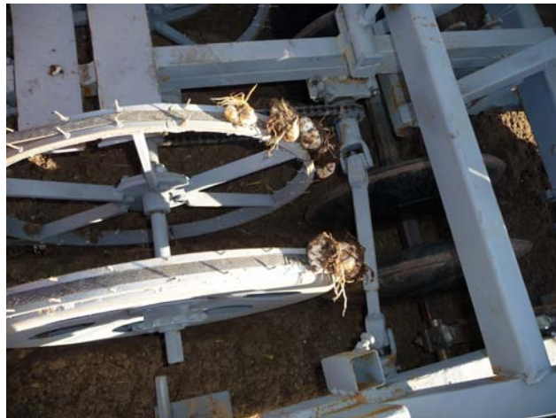
ציור 1 - הצבת הפקעות בנעיצה על הקרוסלה האנכית עם השורשים קלפי מעלה
