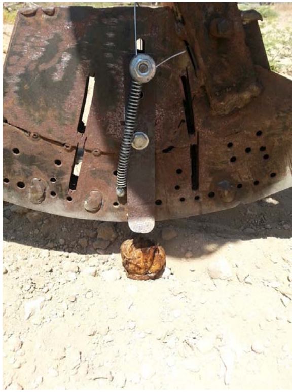
צור 8, הפקעת משתחררת לקרקע כתוצאה מנסיגת הקפיצים לתוך הקרוסלה.
