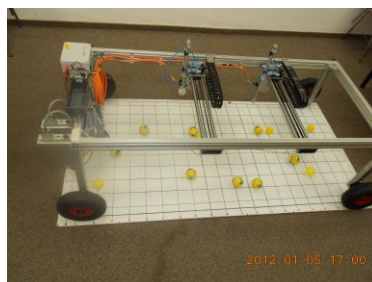
איור 18. תצורת YZ, שתי זרועות עובדה במקביל, מבט כללי.
