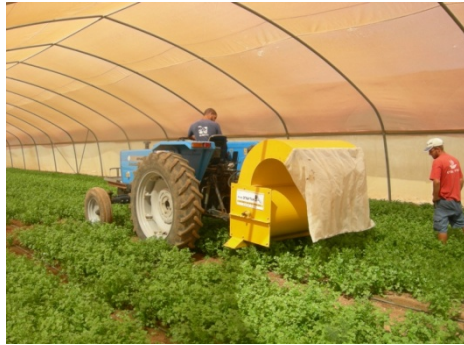
תמונה 2. שואב חרקים בעל יכולת לשאיבה ופליטה של זרמי אוויר בחממת גידול פטרוזיליה.
