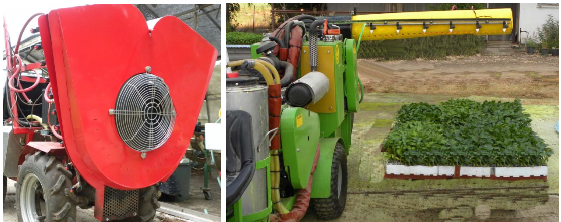
תמונה 1. המרססים ליישום מסחרי. ימין מרסס שרוול אויר אופקי, שמאל, מרסס מפוח מוצא משתנה משופר.
