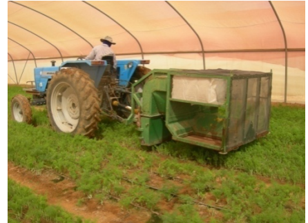
תמונה 1. שואב חרקים בעל מערכת לשאיבה בלבד - בחממת פטרוזיליה.
