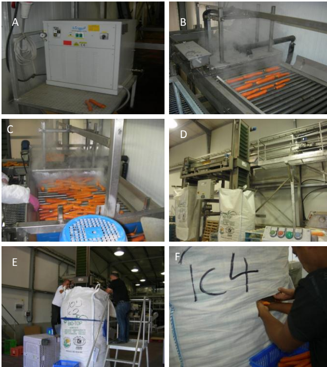
איור 15: יישום קיטור במערך אריזה מסחרי. (A) מחולל הקיטור (B, C) פעולת הקיטור על גבי מסוע הגזר בתנאי כול ובעומס מסחרי, בהתאמה. (D) אריזה בצובר ייעודיים. (E) החדרה של חיישני טמפרטורה ולחות לשכבה העליונה בצובר. (F) שיטת הדגימה משכבות שונות בצובר.
