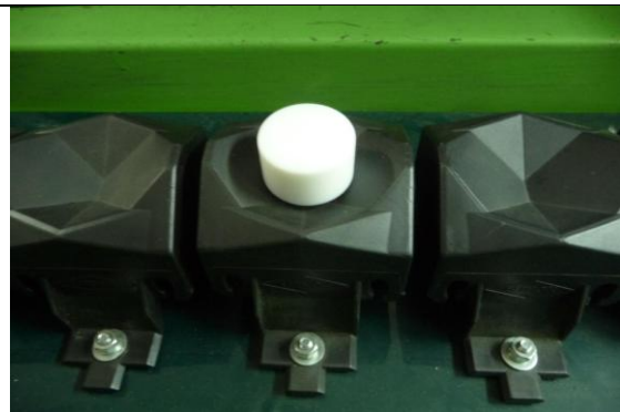
תמונה 5: מתקן החזר קבוע למדידת רפרנס לבן בתנועה
