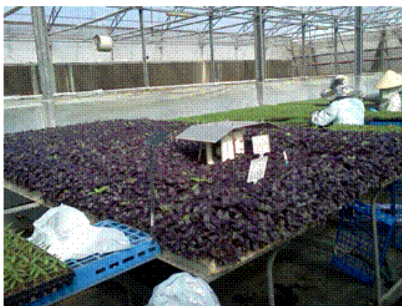
תצלום 4. מדידת טמפרטורה ולחות באזור הגידול. צמד תרמוקפלים לח, יבש הוּשמו ביחידה מאווררת מוגנת מקרינת שמש ישירה והונחו על שולחנות הגידול שבחממה.
