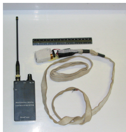
איור 5א. הציוד לניטור אקוסטי עבור צאן – תצורה 1
