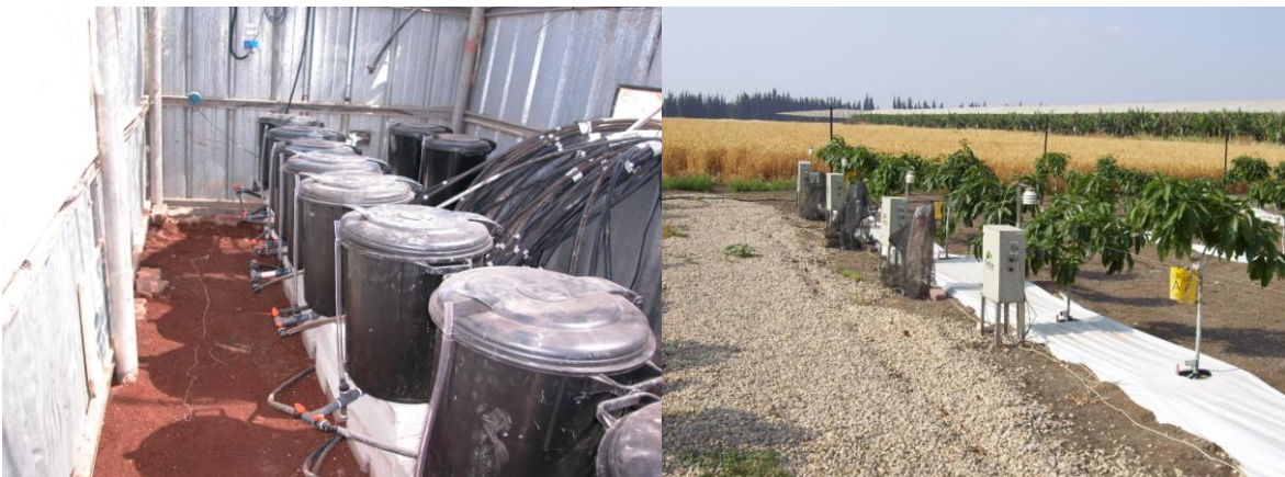
תמונה 3. שמאל: כלים לאיסוף נקז; ימין: מערכות מדידה של קוטר הגזע (דנדרומטרים).
