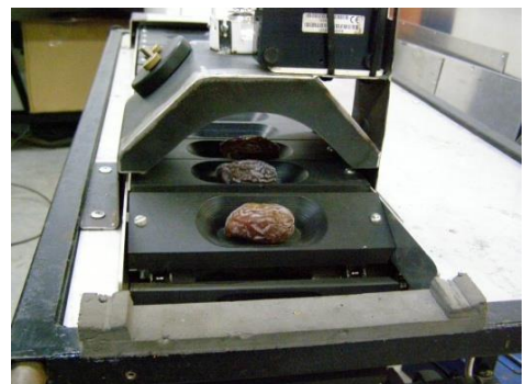
איור מס' 1: תא בדיקה עם יחידת תאורה בעלת שליטה על עצמת התאורה לשילוב ספקטרומטר
