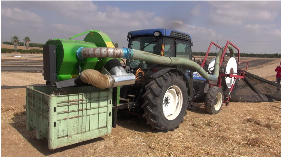
איור 5. מערכת לאיסוף גרעינים בגלגול ושאיבה, מערכת הגלגול לפני הטרקטור והשאיבה מאחוריו
