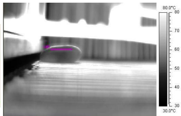
ציור 11 - תפ"א בין קו הפומיות הראשון והשני (מימין). קו המדידה המסומן על החלק העליון של המוצר מראה כי טמפרטורת השטח החם בפני המוצר היא בסביבות 57 מ"צ.
