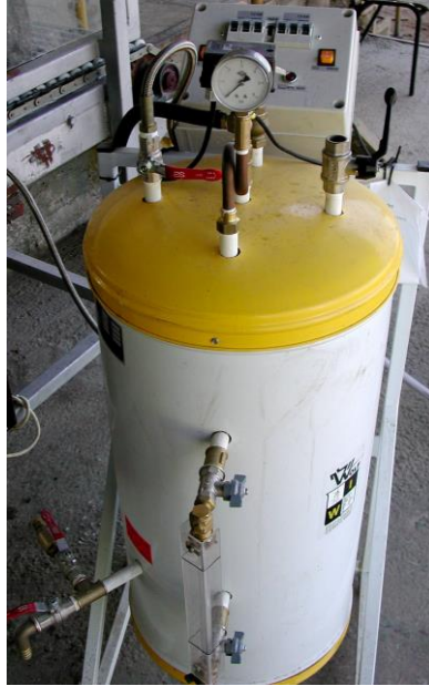
ציור 1 - דוד קיטור חשמלי בעל הספק של 15 kW שהותאם להספקת קיטור למערכת הפומיות.
