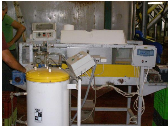
תמונה 16 - המערכת לחיטוי טרמי מוצבת ליד המערכת לקרור במים בעת ניסויים בבית האריזה בשלוחות.
