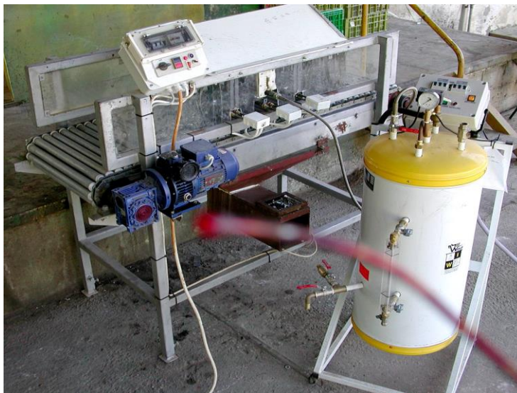
ציור 4 - מבט כללי של כל מערכות המשנה לניסוי החיטוי בקיטור.
