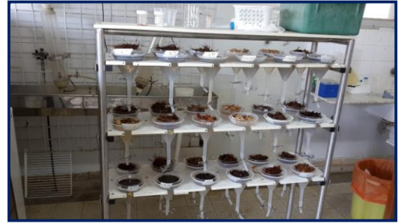
איור 17: מתקן ל"משפכי ברמן" למיצוי נמטודות ממצע גידול או קרקע. הנמטודות נאספות בתחתית המשפך ונלקחות לספירה לאחר 24 שעות.
