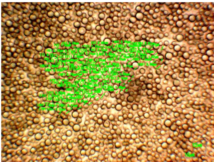
ציור 6 – מדידת קטרי הטיפות השמן במים לאחר ריסוק בהומוגניזר, מבוצעים באמצעות סרגל וירטואלי
