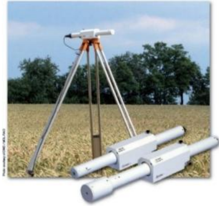
איור 3: מערכת הסינטיילומר אשר הוצבה בשדה שיבולת השועל.
