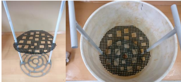
איור 18. אב טיפוס בשלבי הכנה וניסוי התכנות: מסגרת נשלפת לאיתור וכימות השורשים.
