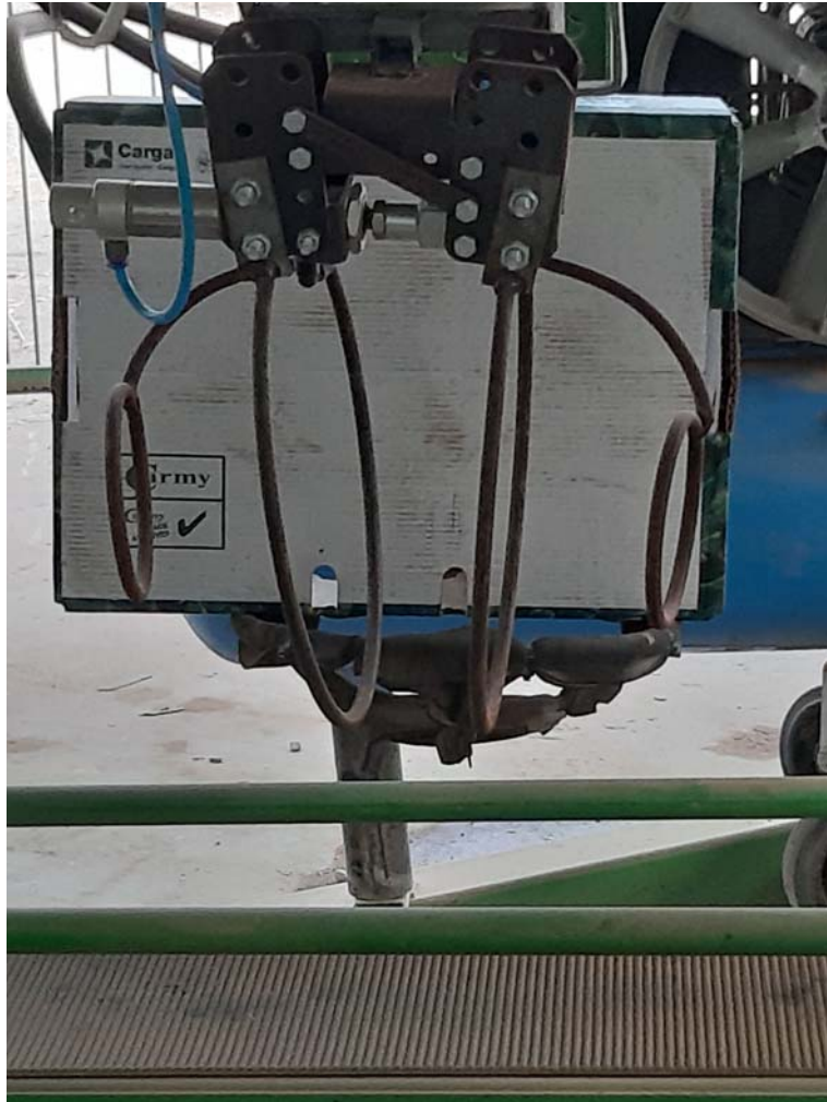
איור 6. התפסנית החדשה. טבעות אחיזה ראשיות בקוטר 230 מ"מ וטבעות
