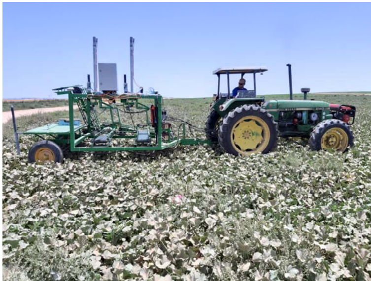
איור 5. רובוט בעל שתי זרועות רתום לטרקטור. מסוע רוחבי צמוד לכל זרוע, מניע מלונים אל מסוע ארכי המעלה אותם אל משטח קבלה.
