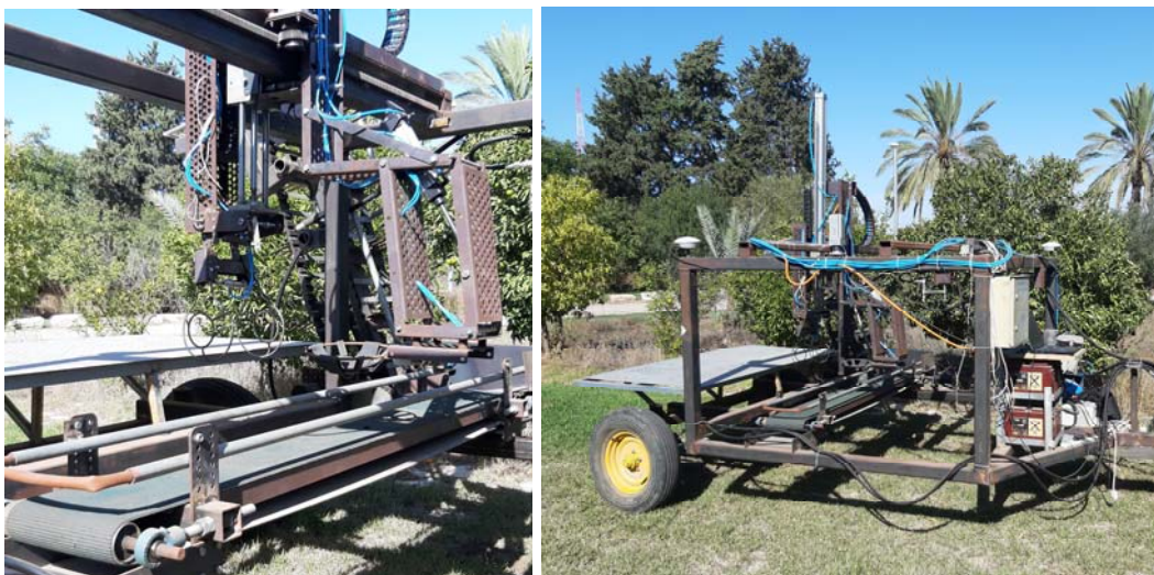
איור 3. הרובוט החדש בעל זרוע אחת פניאומטית. מבט מקיף ומבט מקרוב אל התפסנית ומנגנון קבלת המלון.
