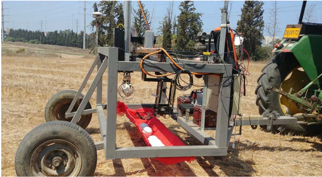
איור מספר 1. תוצר המחקר הקודם- אבטיפוס רובוט אסיף מלונים.
